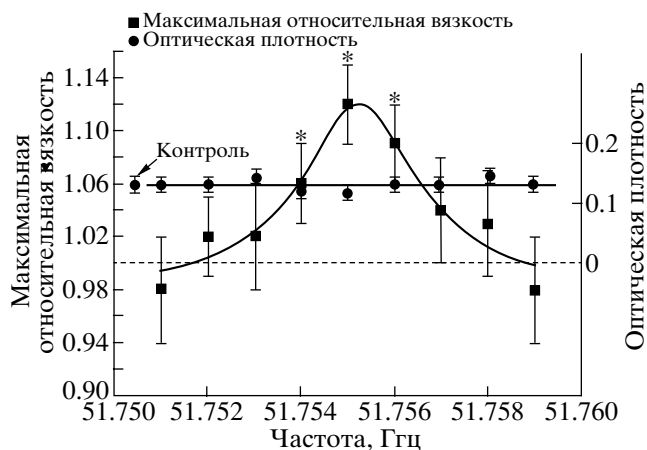
Рис. 5. Зависимость максимальной относительной вязкости и оптической плотности клеточной суспензии после облучения ММВ (время облучения 10 мин, ППЭ = 10^{-18} Вт/см 2 ).
